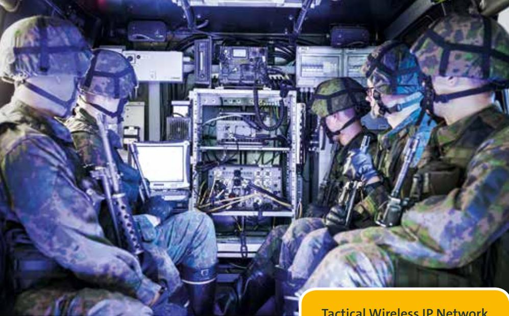
**Tactical Wireless IP Network (TAC WIN) Funkgeräte ermöglichen die Übertragung von Breitband-Daten und Sprache an alle mobilen Truppenteile**
