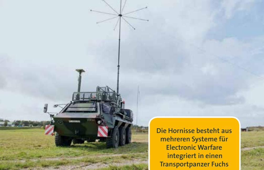
**Die Hornisse besteht aus mehreren Systemen für Electronic Warfare integriert in einen Transportpanzer Fuchs**
