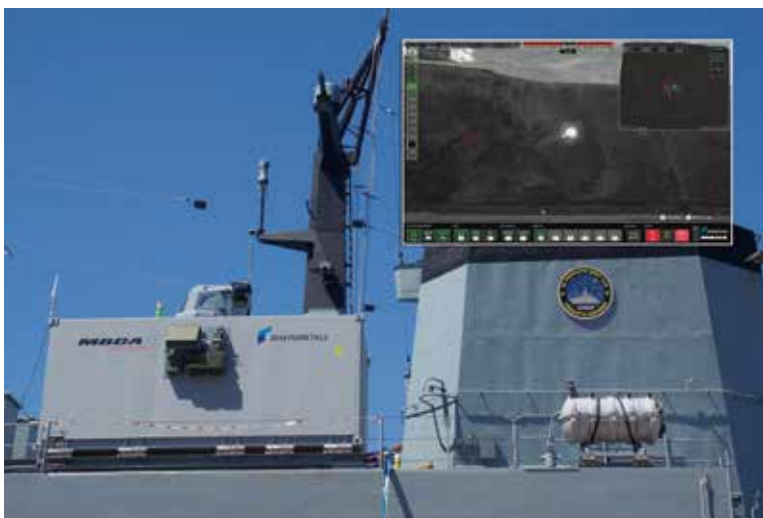
Laserwaffendemonstrator HoWiSM auf der Fregatte „Sachsen“: Bei der Systemerprobung bekämpfte die Fregatte im Sperrgebiet Putlos erfolgreich Drohnen im Nah- und Nächstbereich.
