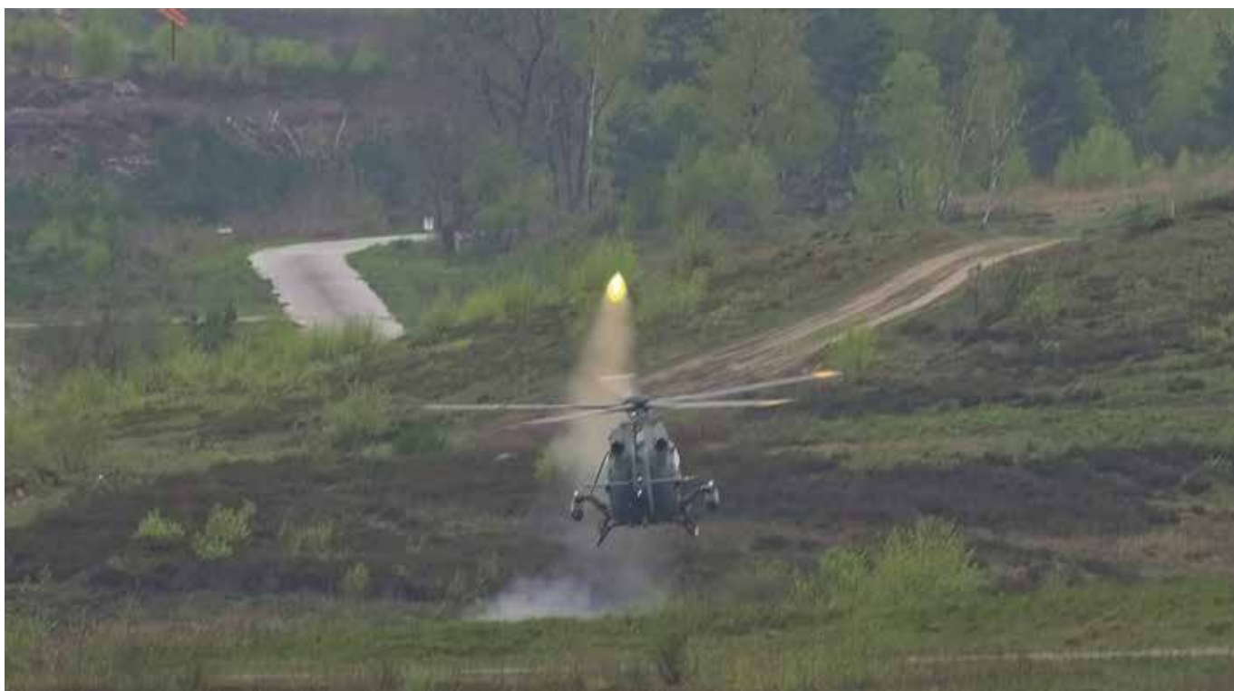
Prototyp des H145M beim scharfen Schuss einer 70mm-Rakete, Heckansicht.
