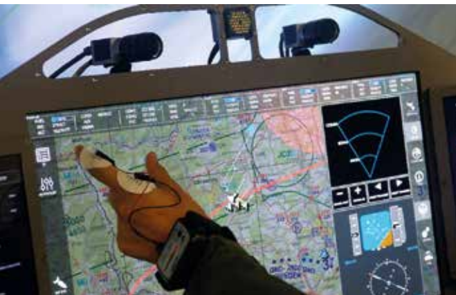
Pilot mit Bio-Sensorik im Kampfflugzeug-Cockpit aus dem Projekt „MissionLab“.
