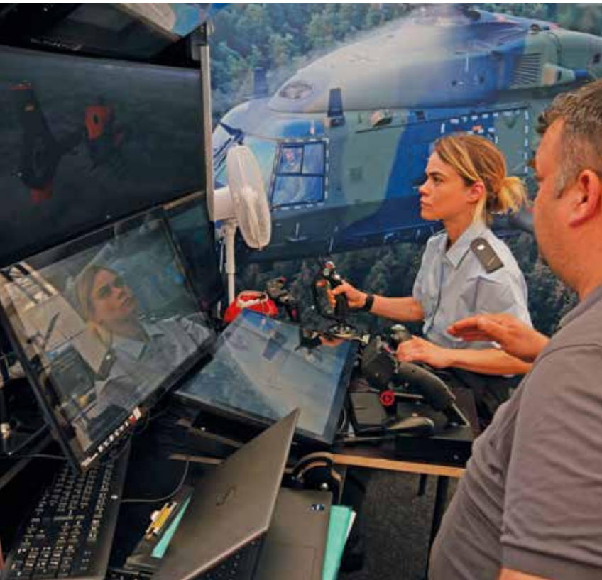
Der Helicopter Advanced Tool Simulator dient dem Training für den Spezialkräfte-Hubschrauber H145M.
