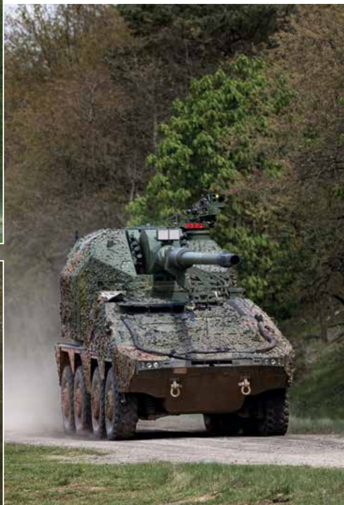
Reifegradanalyse zur Feststellung des Entwicklungsstandes der RCH 155: Die auf dem GTK Boxer basierende Radhaubitze ist das erste System, mit welchem Soldatinnen und Soldaten aus der Fahrt heraus im indirekten Feuer schießen und genau treffen können.
