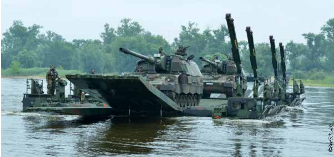
Amphibie M3 des schweren Pionierbataillons 901 beim Übersetzen von zwei Panzerhaubitzen 2000 über die Elbe.
