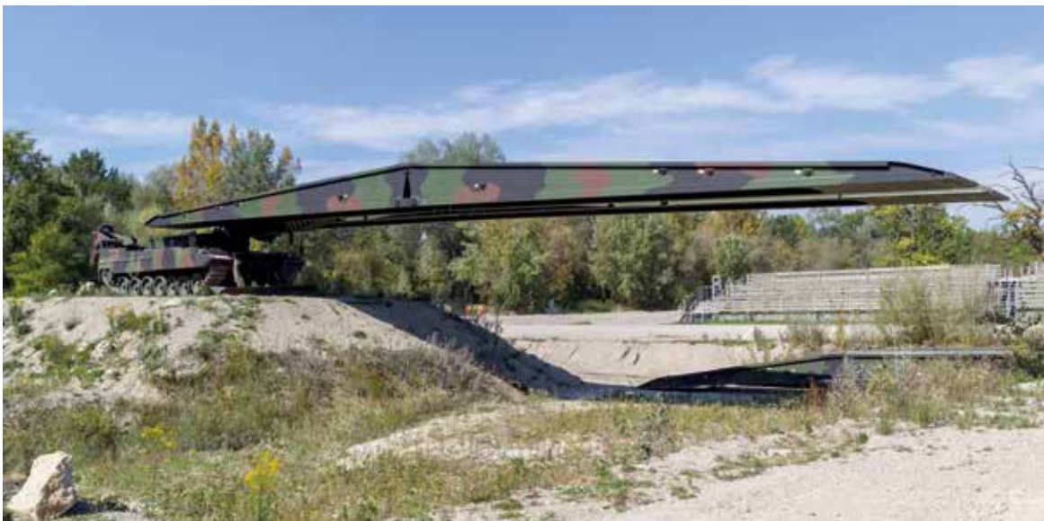
Mit einer Gefechtsfeldbrücke Leguan wird ein Gelände Hindernis auf dem Pionierübungsplatz der Pionierschule in Ingolstadt überwunden.
