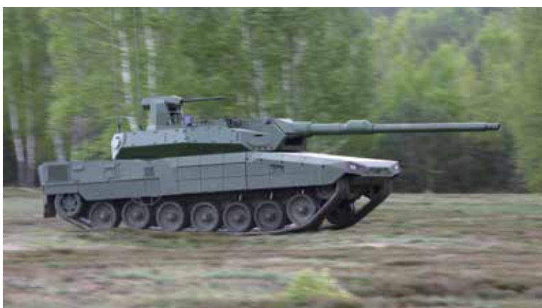
Der Leopard 2 A-RC 3.0 hat einen unbemannten Turm und benötigt nur drei Mann Besatzung.
