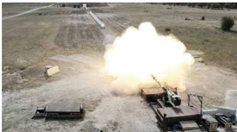
Erprobungsschießen mit dem ASCALON-System. Es ermöglicht den Wechsel des Rohrkalibers von 120 mm auf 140 mm in weniger als einer Stunde.
