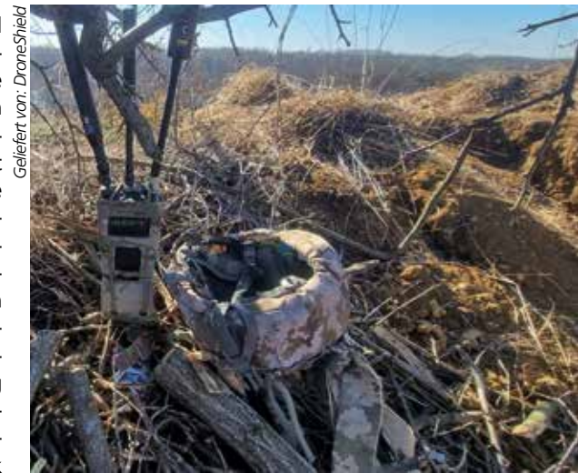
Das Drohnenerkennungsgerät RfPatrol Mk2 von DroneShield wird in der Ukraine eingesetzt.
